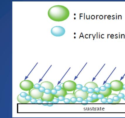
Fluororesin/Acrylic-resin giúp màng sơn chịu được thời tiết khắc nghiệt, khả năng kháng hóa chất và chống bám bẩn gấp 3 lần các loại sơn truyền thống.
